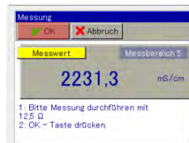
Bei Kalibrieradapter 12,5 \Omega einstellen, OK Taste drücken
