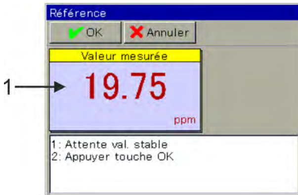
Fig. 83 : Valeur de mesure basée sur les valeurs d'étalonnage actuelles (pos. 1)
