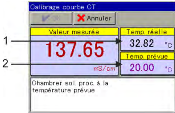
Fig. 73 : Étalonnage de la courbe CT
