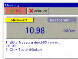
2. Messung bei 2,5 K \Omega , OK Taste erneut drücken
