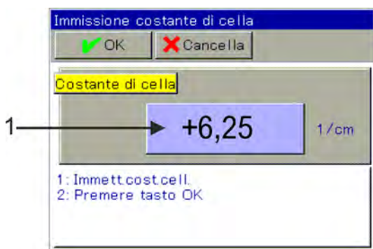
Fig. 76: Per inserire, premere il pulsante (Pos. 1)
