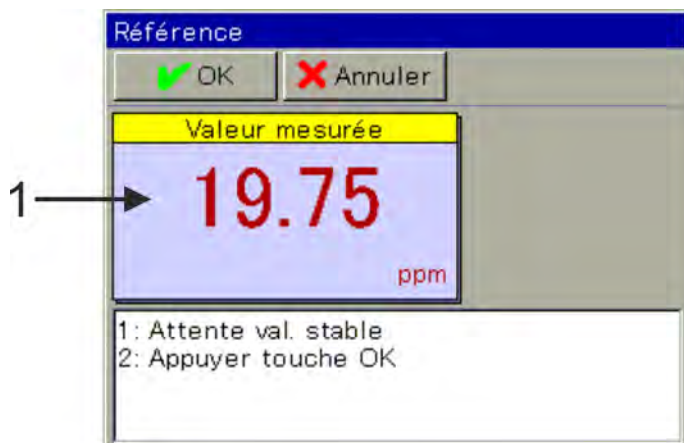
Fig. 81 : Valeur de mesure basée sur les valeurs d'étalonnage actuelles (pos. 1)
