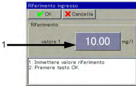
Fig. 82: Per inserire il valore di riferimento della soluzione tampone, premere il pulsante (Pos. 1)
