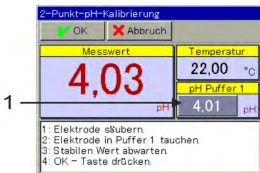
Abb. 64: Zur Eingabe des pH-Wertes der Pufferlösung: Schaltfläche antippen (Pos. 1)
