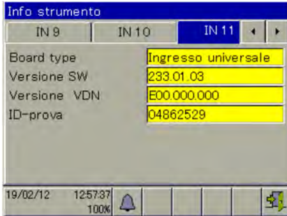
Fig. 32: Vista esempio: Informazioni hardware di una scheda opzionale "ingresso universale"
