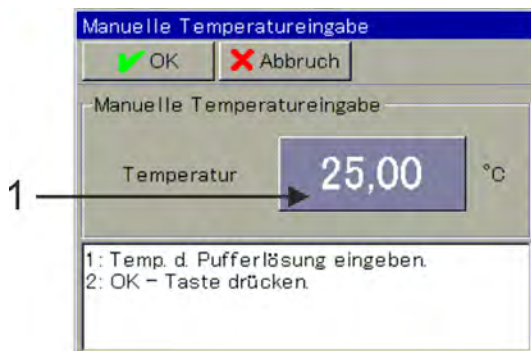
Abb. 63: Zur Temperatureingabe: Schaltfläche antippen (Pos. 1)
