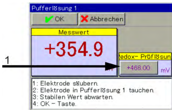
Abb. 67: Zur manuellen Änderung des Redoxwertes der Prüflösung, Schaltfläche antippen (Pos. 1)
