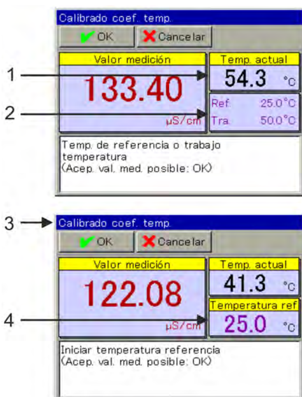
Fig. 69: Calibración del coeficiente de temperatura
