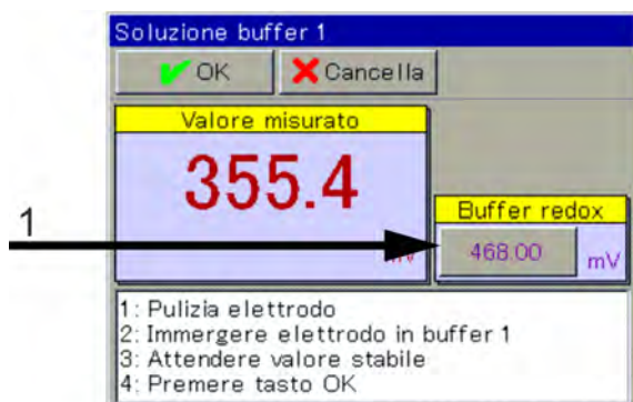
Fig. 67: Per modificare manualmente il valore redox della soluzione di prova, premere il pulsante (Pos. 1)
