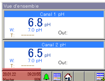
Appuyer sur le bouton marqué pour entrer dans le menu de l'appareil
