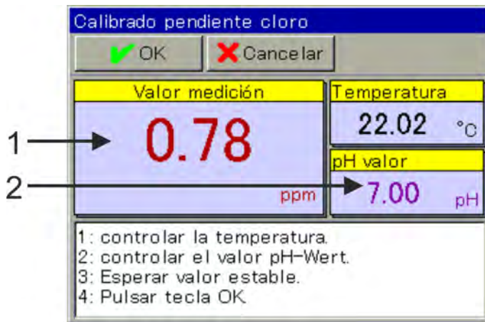
Fig. 85: Calibración transconductancia cloro Introducción del valor pH
