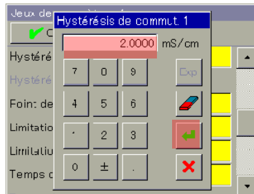
Régler l'hystérésis de commutation sur 2,0000 mS/cm, appuyer sur Entrée
