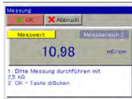
Bei Kalibrieradapter 2,5 K \Omega einstellen, OK Taste drücken
