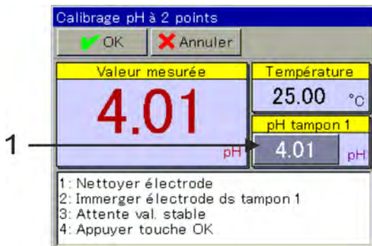
Fig. 66 : Pour la saisie de la valeur pH de la solution tampon, appuyez sur le bouton (pos. 1)
