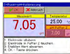
Wert für Puffer 2 einstellen (7,00), Sonde in die entsprechende Pufferlösung tauchen, OK Taste drücken
