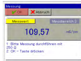
Bei Kalibrieradapter 250 \Omega einstellen, OK Taste drücken
