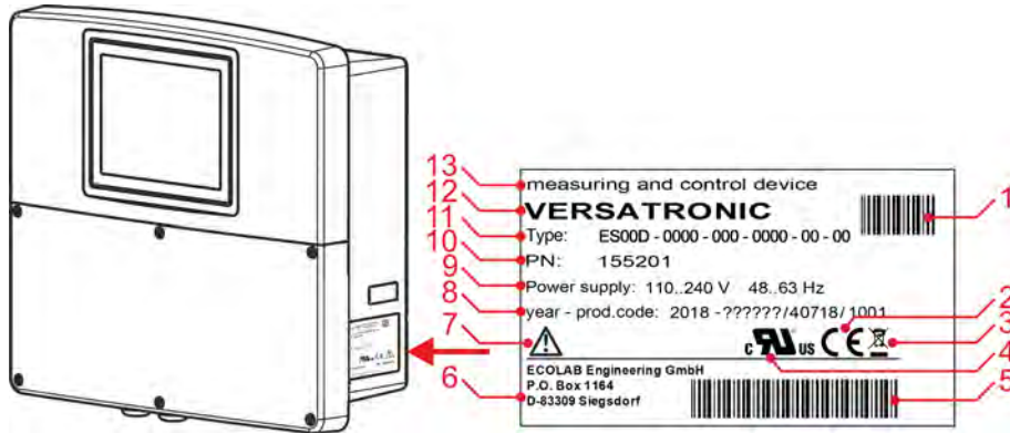
Fig. 3: Targhetta sull'alloggiamento del dispositivo
