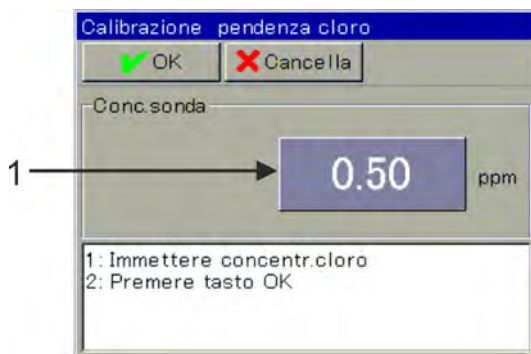
Fig. 86: Per inserire la concentrazione di cloro, premere il pulsante (Pos. 1)
