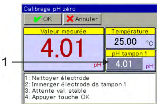
Fig. 64 : Pour la saisie de la valeur pH de la solution tampon : Appuyer sur le bouton (pos. 1)
