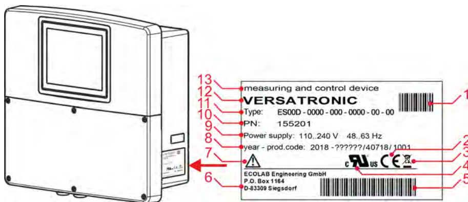
Fig. 3 : Plaque signalétique sur le boîtier de l'appareil
