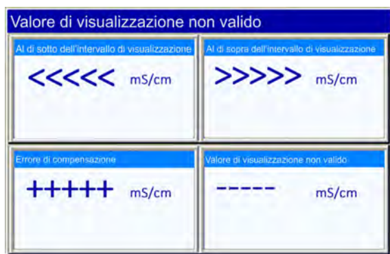
Fig. 38: Esempio di visualizzazione valore non valido
