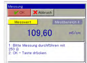
2. Messung bei 250 \Omega , OK Taste erneut drücken
