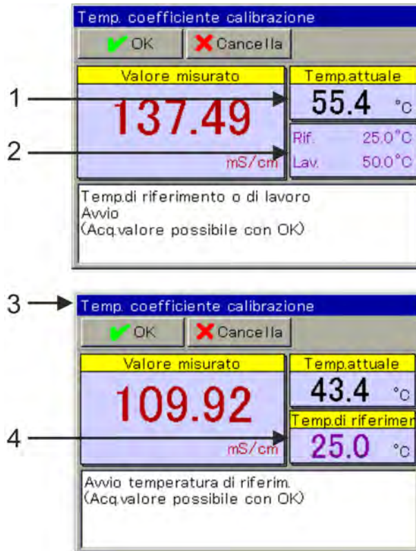
Fig. 72: Calibrazione del coefficiente di temperatura (non lineare)
