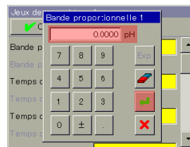
Régler la bande proportionnelle sur un pH de 0,0000, appuyer sur Entrée
