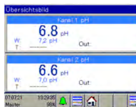
Wert für Puffer 2 einstellen (7,00), Sonde in die entsprechende Pufferlösung tauchen, OK Taste drücken
