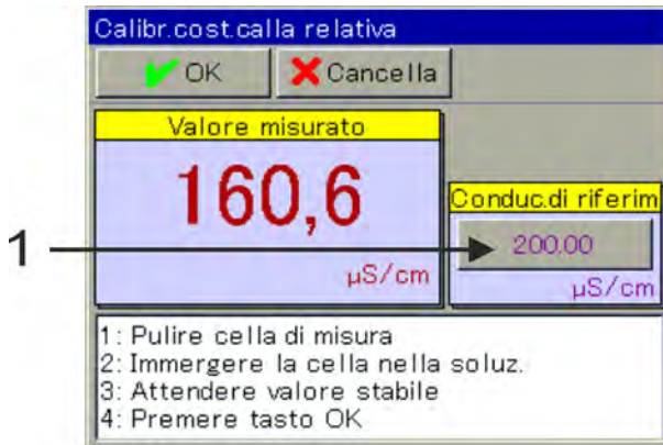
Fig. 68: Per modificare la conducibilità di riferimento, premere il pulsante (Pos. 1)
