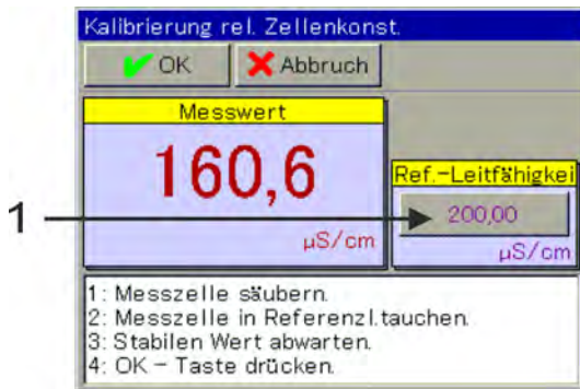
Abb. 68: Zur Änderung der Referenzleitfähigkeit, Schaltfläche antippen (Pos. 1)
