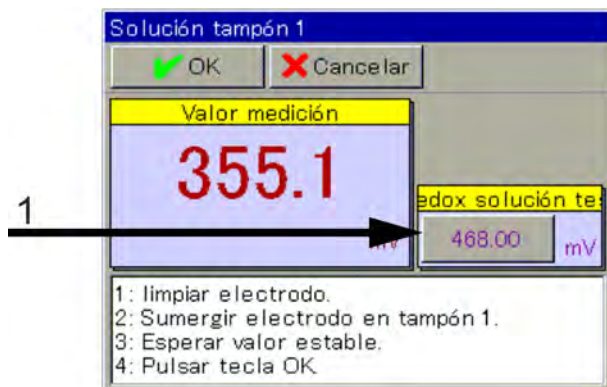
Fig. 67: Para la modificación manual del valor Redox de la solución de ensayo, tocar el botón de selección (pos. 1)
