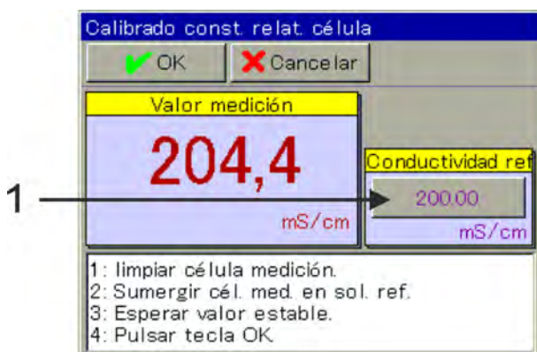
Fig. 70: Para modificar la conductividad de referencia, tocar el botón de selección (pos. 1)
