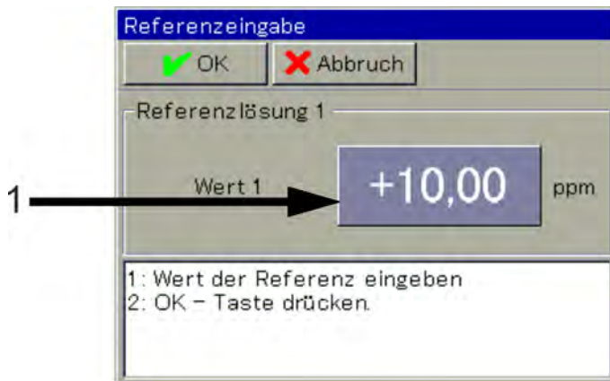
Abb. 82: Zur Eingabe des Referenzwertes der Prüflösung, Schaltfläche antippen (Pos. 1)
