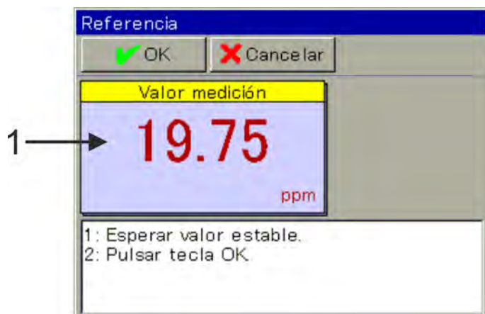
Fig. 83: Valor de medición basado en valores de calibración anteriores (pos. 1)
