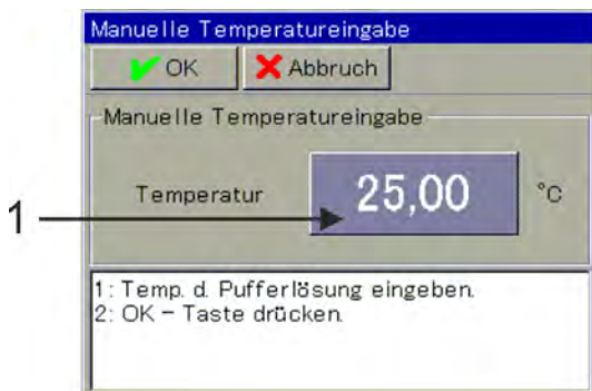
Abb. 65: Zur Temperatureingabe, Schaltfläche antippen (Pos. 1)
