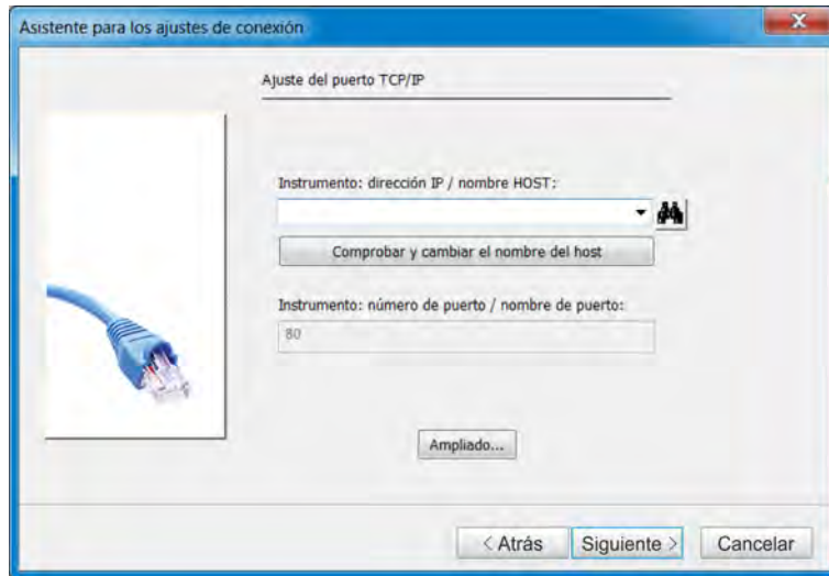
Fig. 110: Cuadro de diálogo de configuración: ajustes del puerto TCP/IP
