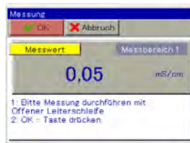
Messung mit offener Leiterschleife durchführen, OK Taste drücken
