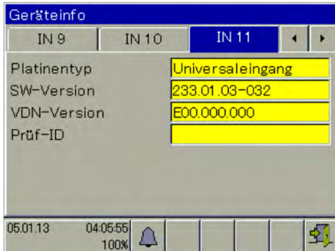
Abb. 32: Beispielsicht: Hardware- Informationen einer Optionsplatine "Universaleingang"
