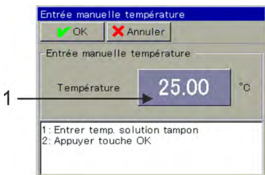
Fig. 63 : Pour la saisie de température : Appuyer sur le bouton (pos. 1)
