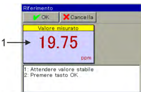
Fig. 81: Valore misurato basato su valori di calibrazione precedenti (Pos. 1)
