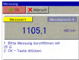
Bei Kalibrieradapter 25 \Omega einstellen, OK Taste drücken
