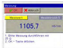
2. Messung bei 25 \Omega , OK Taste erneut drücken
