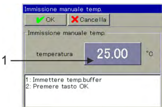
Fig. 65: Per inserire la temperatura, premere il pulsante (Pos. 1)
