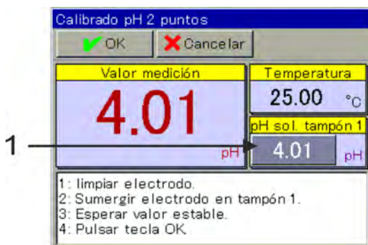
Fig. 66: Para introducir el valor pH de la solución tampón, toque el botón (pos. 1)
