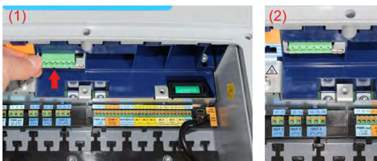
Fig. 96 : Enfichage de la platine en option
