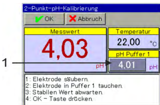
Abb. 66: Zur Eingabe des pH-Wertes der Pufferlösung, Schaltfläche antippen (Pos. 1)
