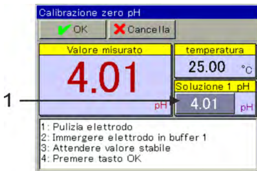
Fig. 64: Per inserire il pH della soluzione tampone: Toccare il pulsante (Pos. 1)
