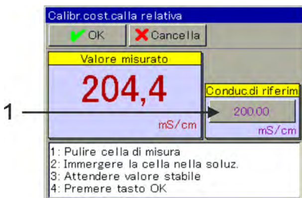
Fig. 70: Per modificare la conducibilità di riferimento, premere il pulsante (Pos. 1)
