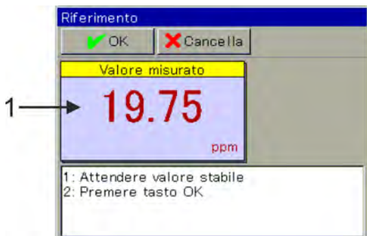
Fig. 83: Valore misurato basato su valori di calibrazione precedenti (Pos. 1)
