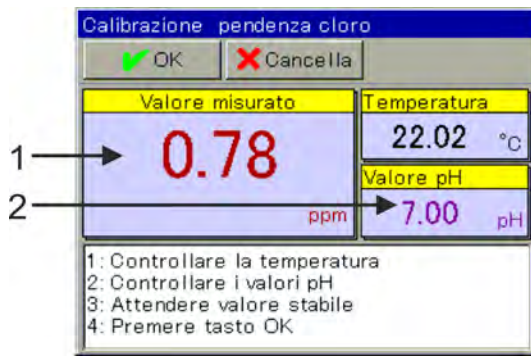
Fig. 85: Calibrazione pendenza cloro: Inserimento del valore di pH
