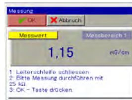
Leiterschleife des Kalibrieradapters doppelt durch die Sonde schleifen und schließen, 25 K \Omega einstellen, OK Taste drücken
