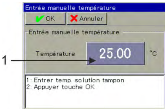
Fig. 65 : Pour la saisie de température, appuyez sur le bouton (pos. 1)
