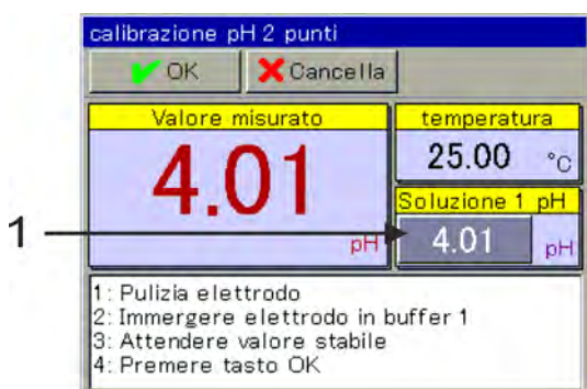
Fig. 66: Per inserire il valore pH della soluzione tampone, premere il pulsante (Pos. 1)
