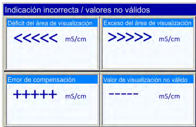
Fig. 38: Indicación de ejemplo valores no válidos
