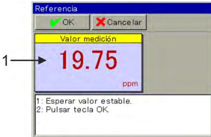
Fig. 81: Valor de medición basado en valores de calibración anteriores (pos. 1)
