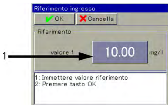
Fig. 84: Per inserire il valore di riferimento della soluzione tampone, premere il pulsante (Pos. 1)
