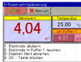
Wert für Puffer 1 einstellen (4,01), Sonde in die entsprechende Pufferlösung tauchen, OK Taste drücken
