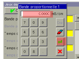
Régler la bande proportionnelle sur 0,0000 mS/cm, appuyer sur Entrée
