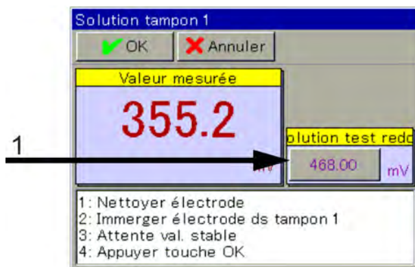
Fig. 67 : Pour modifier manuellement la valeur rédox de la solution de contrôle, appuyez sur le bouton (pos. 1)
