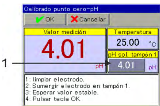
Fig. 64: Para introducir el valor de pH de la solución tampón: Tocar el botón de selección (pos. 1)
