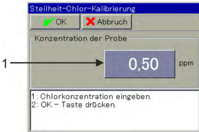
Abb. 86: Zur Eingabe der Chlorkonzentration, Schaltfläche antippen (Pos. 1)
