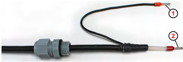
Abb. 12: Einfach geschirmtes Anschlusskabel
