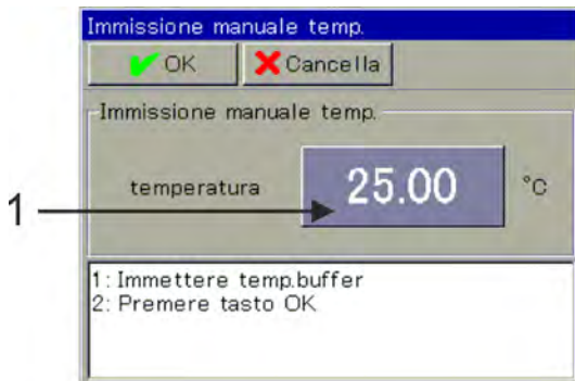
Fig. 63: Per l'input di temperatura: Toccare il pulsante (Pos. 1)
