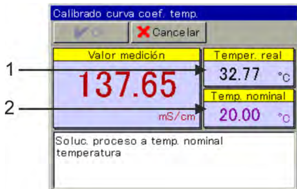
Fig. 73: Calibración de la curva CT
