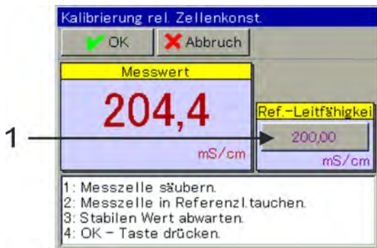
Abb. 70: Zur Änderung der Referenzleitfähigkeit, Schaltfläche antippen (Pos. 1)
