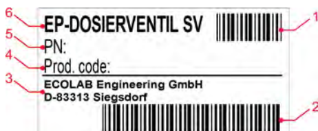
Abb. 6: Typenschild Dosierventil EP
