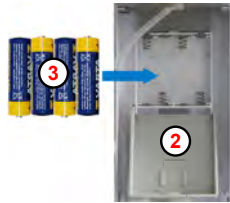
Fig. 3 : Insertion des piles (4 piles AA)
