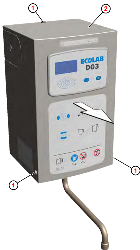
Fig. 17 : Retrait du couvercle de l'appareil (capot) (exemple DG3)
