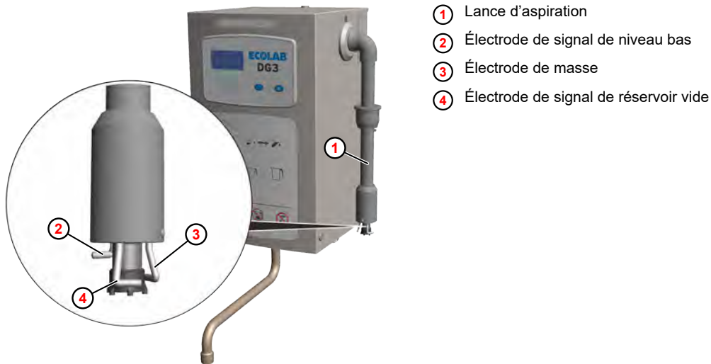
Fig. 15 : Vérification des contacteurs de signal sur la lance d'aspiration
