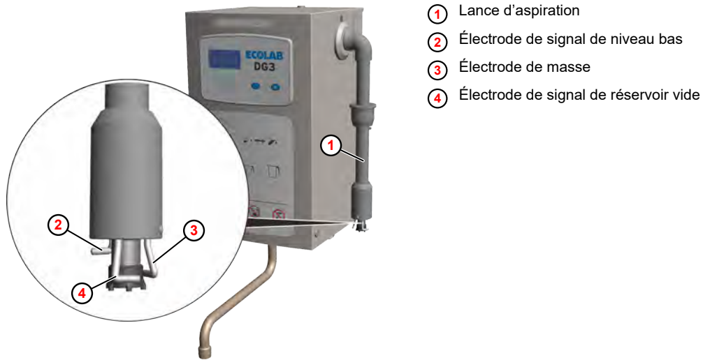
Fig. 12 : Vérification des contacteurs de signal sur la lance d'aspiration
