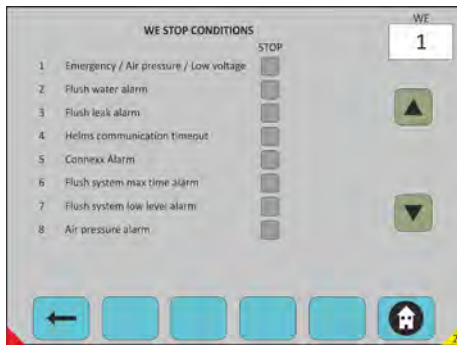
Fig. 40 : Configuration -> Machine -> LE -> États d'arrêt
