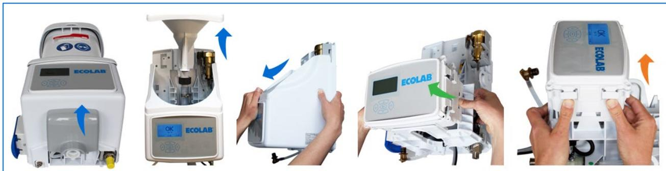
1 Entriegeln und entfernen Sie die **Trichterverriegelung**. | 2 Entfernen Sie den **Trichter**. | 3 Entriegeln Sie das vordere Gehäuse (Knöpfe an den Seiten) und entfernen Sie es. | 4 Drücken Sie auf die beiden Laschen der **Elektronikeinheit**, und heben Sie sie von der Geräterückseite ab. | 5 Entriegeln Sie die vier Laschen des **Elektronikgehäusedeckels** und nehmen Sie diesen ab.
