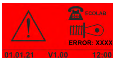
Fig. 31: Rappresentazione «errore cella di misurazione»
