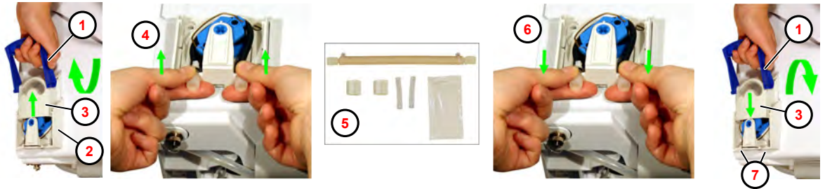
Fig. 21: Sostituzione tubo schiacciato
